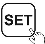
Çalışma modunda iken SET tuşuna 5 saniye basılı tutulduğunda ekranda PR mesajı görünür ve sonrasında parametre menüsüne girilir. Parametre menüsüne girildikten sonra yukarı aşağı tuşlarıyla istenen değerler değiştirilebilir.
